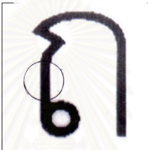
ภาพที่ 4.13 ภาพถ่ายจากกล้องจุลทรรศน์ SZHIO Research Stereo ตัวอักษร “ถ” ขนาด 10 พอยต์ พิมพ์จากเครื่องฉายแสง ความละเอียด 1200 dpi ใช้กำลังขยาย (1.5 x 3 เท่า)
