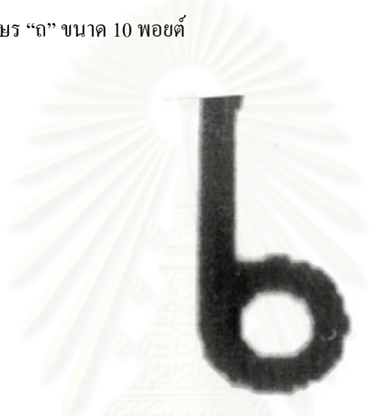
ภาพที่ 4.37 ภาพถ่ายจากกล้องจุลทรรศน์ SZHIO Research Stereo ตัวอักษร “ถ” ขนาด 10 พอยต์ พิมพ์จากเครื่องฉายแสง ความละเอียด 1200 dpi ใช้กำลังขยาย (1.5 x 4 เท่า)
