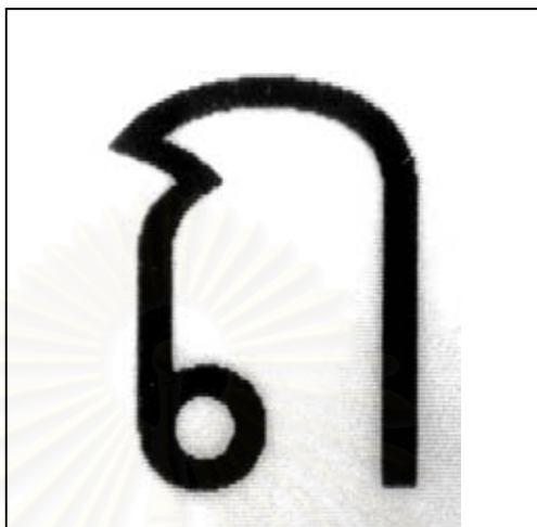
รูปที่ 4.5 ภาพถ่ายจากกล้องจุลทรรศน์ SZHIO Research Stereo ตัวอักษร “ถ” ขนาด 16 พอยต์ พิมพ์จากเครื่องฉายแสง ความละเอียด 1200 dpi ใช้กำลังขยาย (1.5 x 2 เท่า)
