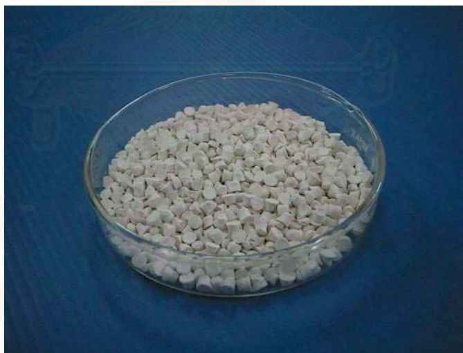
รูปที่ 3.3 ซีโอดีที่ผ่านการขึ้นรูปให้เป็นเม็ดทรงกระบอก
