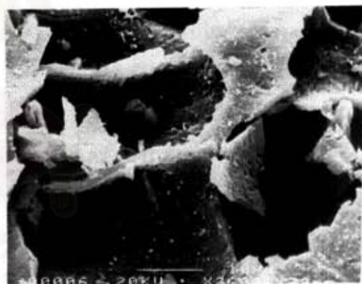
รูปที่ 4.29 ผิวถ่านกัมมันต์ที่ได้จากการกระตุ้นด้วยแก๊สออกซิเจน (0.6 ลิตรต่อนาที)
