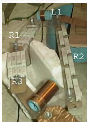
รูปที่ 3-4 : แสดงวงจรหลักของเครื่องกำเนิดอิมพัลส์คลื่นผสม
