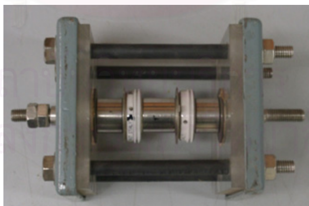
รูปที่ 5-4 : แสดงชุดประกอบในกรณีใช้ SCR หลายตัว
