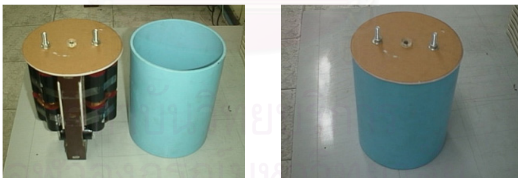
รูปที่ 3-16 : ตัวเก็บประจุคัปปลิงที่ประกอบเสร็จแล้ว
