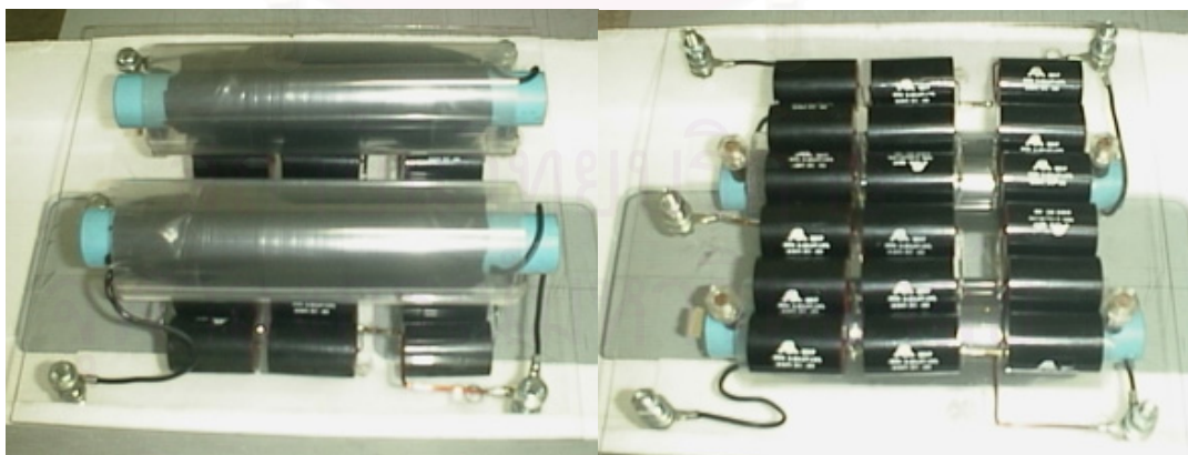
รูปที่ 3-19 : แสดงวงจรดีคัปลิงที่สร้างเสร็จแล้ว
