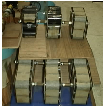
รูปที่ 3-5 : แสดงตัวเก็บประจุที่ออกแบบและประกอบเสร็จแล้ว
