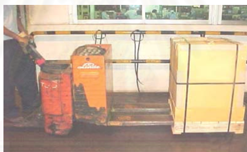
รูปที่ 4.20 การเคลื่อนย้ายด้วย Power lift
