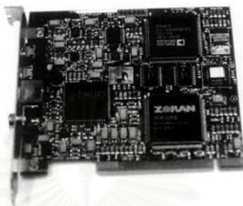
รูปที่ 3.19 แผงวงจรแปลงสัญญาณภาพเป็นข้อมูลภาพของไมโครคอมพิวเตอร์
