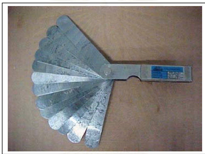
รูปที่ 4.3 ชุดฟีลเลอร์เกจ สำหรับส้อมตรวจสอบระยะวาล์ว
