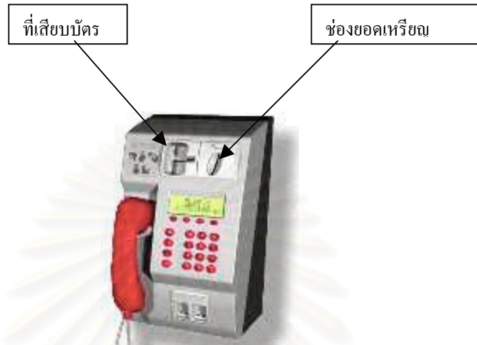
รูปที่ 2.3 แสดงเครื่องโทรศัพท์สาธารณะแบบหยอดเหรียญหรือใช้การ์ด
