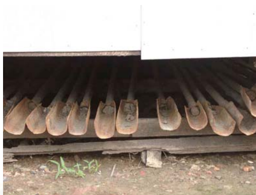
รูปที่ 4.41 เสียมยาวที่ใช้ขุดดินเพื่อตอกเสาเข็ม
