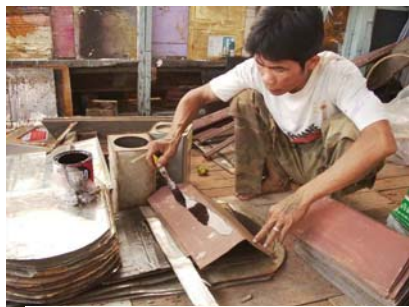
รูปที่ 5.11.14 แสดงการทำสีกันสนิมที่ปั๊บนึ่ง ที่ใช้มุงหลังคา
