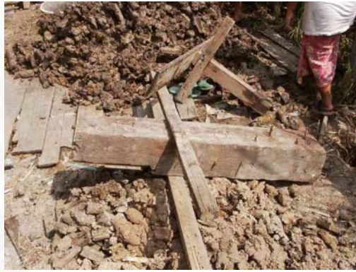
รูปที่ 4.43 แสดงสองเกลอเอาไว้ตอกเสาเข็ม
