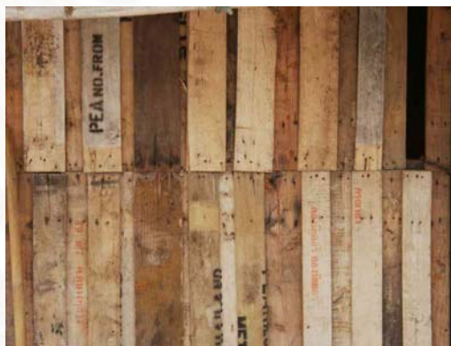
รูปที่ 4.49 แสดงไม้ลังที่เก็บมาจากโรงงานเพื่อใช้ในการสร้างบ้าน
