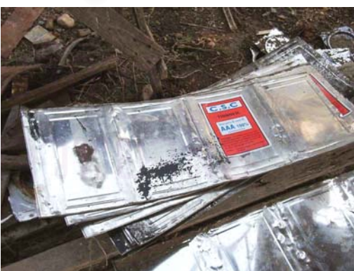
รูปที่ 4.45 แสดงถังปืตี่เป็นแผ่นเพื่อใช้แทนผนัง ของบ้าน
