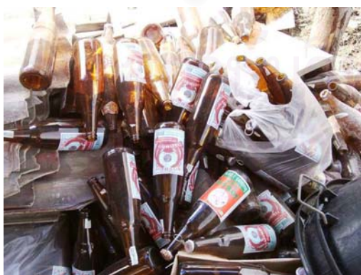
รูปที่ 4.44 แสดงขวดเหล้า ขวดเบียร์ที่ชาวบ้าน เก็บเอาไว้สำหรับตอกแทนเสาเข็มในฐานราก
