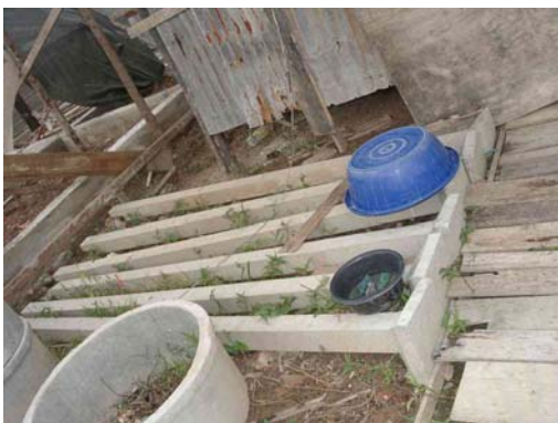
รูปที่ 4.46 แสดงเสาคอนกรีตสำเร็จขนาดต่างๆที่ชาวบ้านมักจะใช้มากกว่าการหล่อเสาเอง
