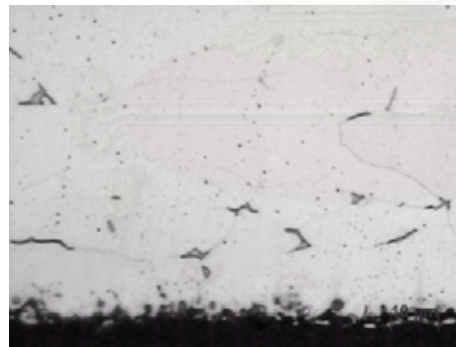
รูปที่ 5.7 โครงสร้างจุลภาคเปรียบเทียบปริมาณซีเมนต์ไต้ที่ความลึกจากผิวต่างๆ กัน
