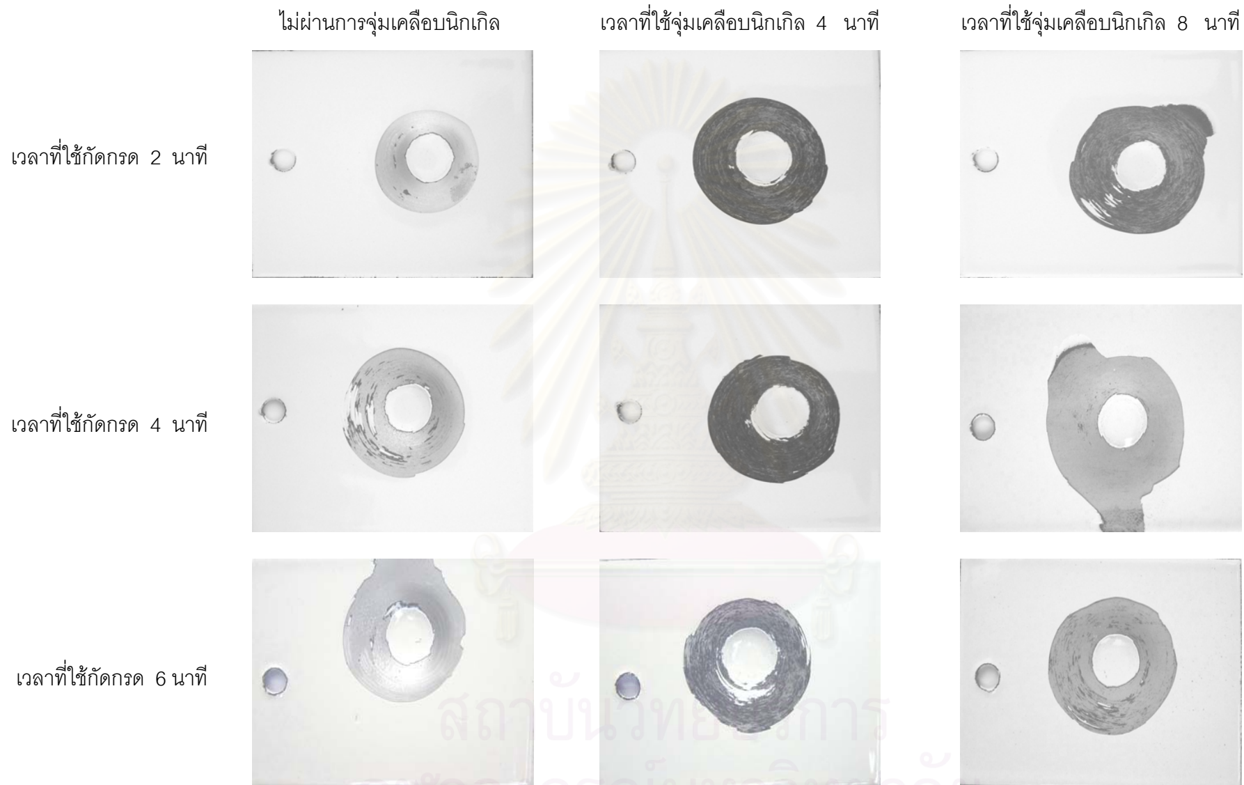
รูปที่ 5.3 ผลการทดสอบการเกาะติดด้วยวิธีการกระแทก เปรียบเทียบผลจากการกัดกรดและการจุ่มนิกเกิลที่เวลาต่างๆกัน
