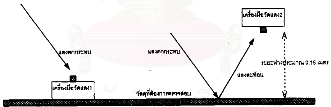
รูปที่ 1.2 รูปแสดงการวัดค่าการสะท้อนแสงของวัสดุ ที่มา : คมกฤษ ชูเกียรติมัน
