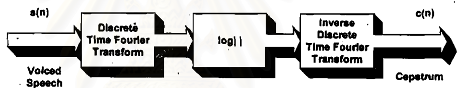
รูปที่ 2.7 กรรมวิธีการหา Real Cepstrum (Deller, Proakis, and Hansen, 1993)
