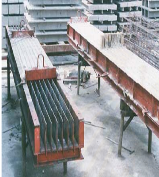
ภาพที่ 5.8 แสดงแบบแม่พิมพ์เหล็กคานสำเร็จรูปโรงงานภายในโครงการ
