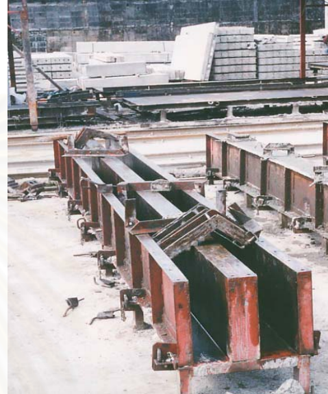
ภาพที่ 5.8 แสดงแบบแม่พิมพ์เหล็กคานสำเร็จรูปโรงงานภายในโครงการ
