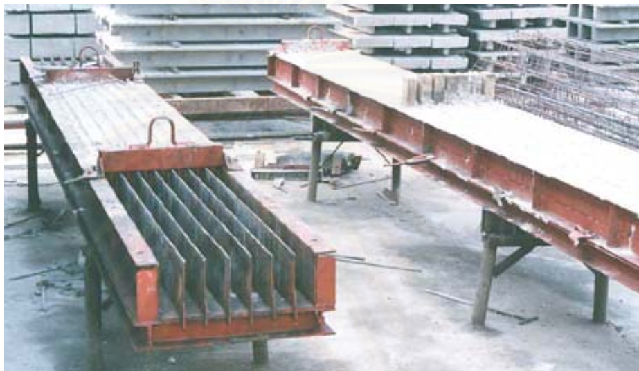
ภาพที่ 5.3 แสดงแบบแม่พิมพ์ คานสำเร็จรูป
