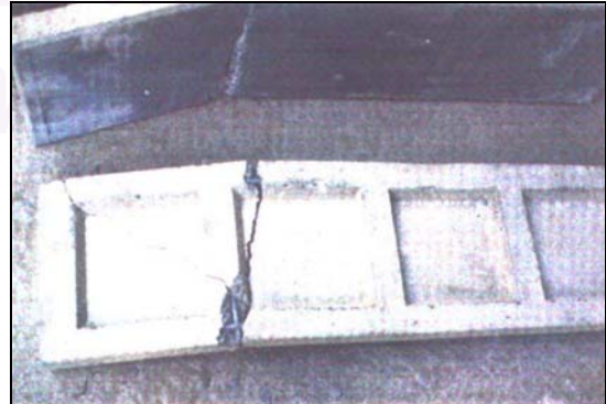
ภาพที่ 4.64 แสดงชิ้นงานบันได ค.ส.ล.ที่ผ่านการทดสอบ
