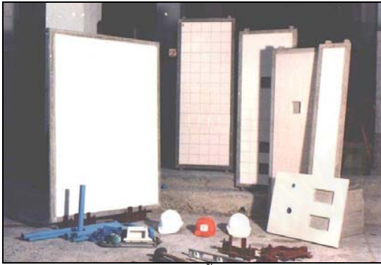
ภาพที่ 4.31 แสดงแผ่นผนังห้องน้ำสำเร็จรูปและอุปกรณ์ต่างๆ
