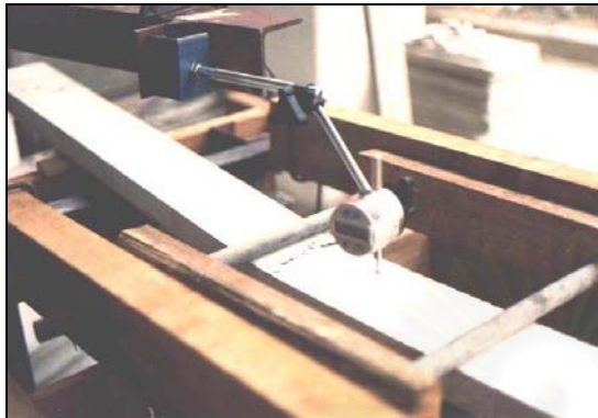
ภาพที่ 4.49 แสดงการทดสอบการรับกำลังด้านข้างของวงกบ
