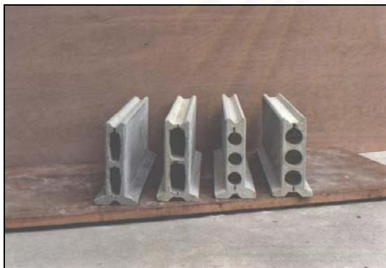
ภาพที่ 4.9 แสดงแผ่นผนังที่ใช้เป็นแบบหล่อเสาโครงสร้าง
