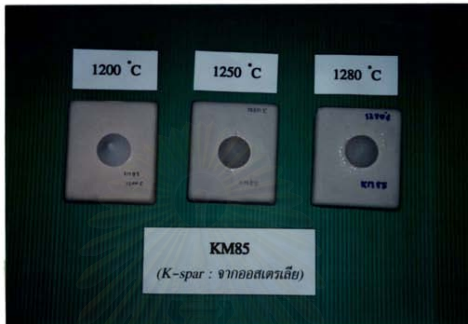
รูปที่ 2.7 การหลอมตัวและสีหลังเผาของ KM85 ที่อุณหภูมิ 1200, 1250 และ 1280 °C
