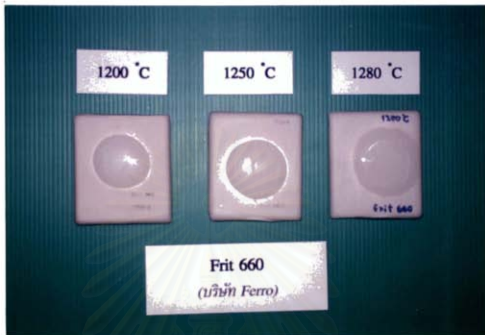
รูปที่ 2.9 การหลอมตัวและสีหลังเผาของ FP660 ที่อุณหภูมิ 1200, 1250 และ 1280 °C
