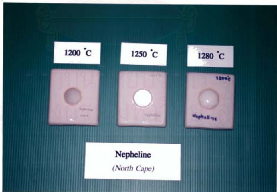
รูปที่ 2.6 การหลอมตัวและสีหลังเผาของ Nepheline Syenite ที่อุณหภูมิ 1200, 1250 และ 1280 °C
