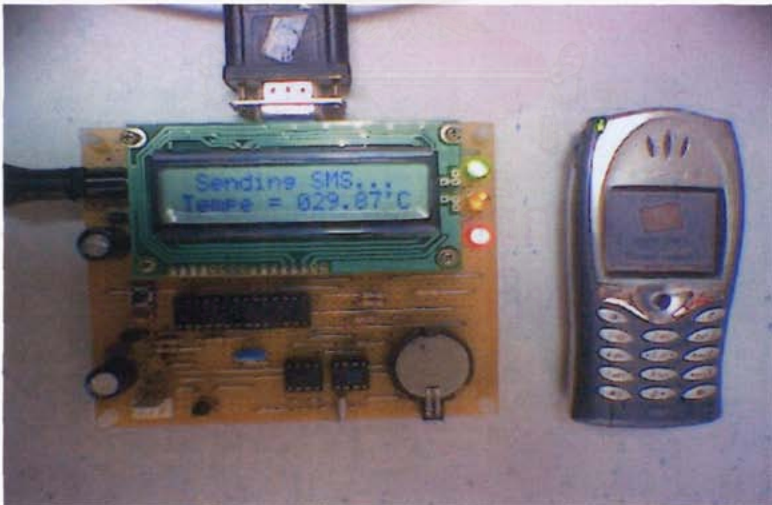
รูปที่ 5.9 ผลการทดลองเมื่อมอดูล GSM Interface กำลังส่งข้อมูลอุณหภูมิที่วัดได้
