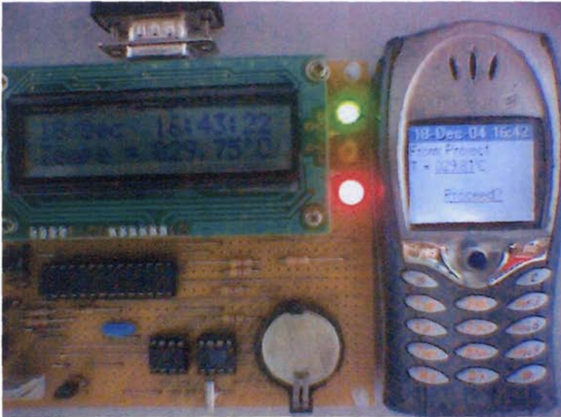
รูปที่ 5.11 ผลการทดลองเมื่อโทรศัพท์เคลื่อนที่ได้รับข้อมูลอุณหภูมิที่ส่งมาจากมอดูล GSM Interface ในรูปที่ 5.10
