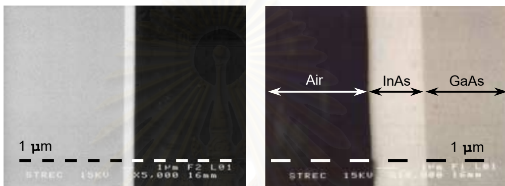
รูปที่ 3.4 ภาพถ่ายความหนาของชั้นอินเดียมอาร์เซไนด์ โดย SEM
