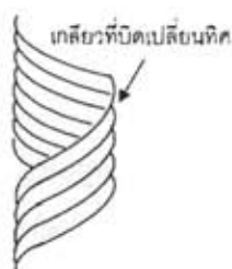
ภาพที่ 3 การเรียงสลับทิศสวนทางกันของสายโซ่โมเลกุลของเส้นใยฝ้าย ที่มา: วีระศักดิ์ (2543)
