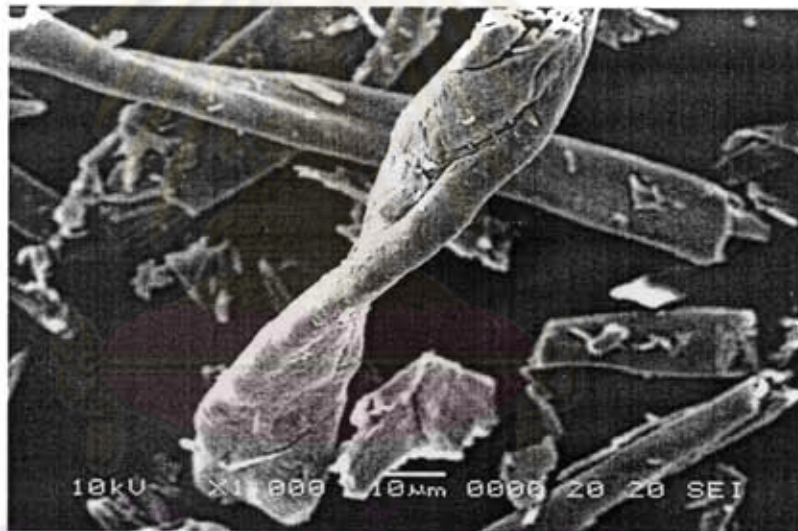
ภาพที่ 22 ภาพถ่าย SEM ของเส้นใยกล้วย
