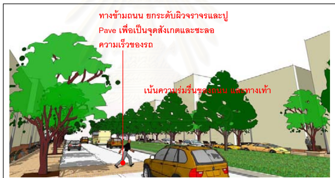
รูปที่ 5-29 ทักษะภาพแนวทางในการปรับปรุงภูมิทัศน์ และการจราจรบนถนนสายหลัก 2
