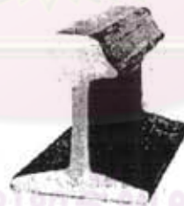
รูปที่ 4.25 การสึกที่ด้านข้างของราง (กิจการร่วมค้า ซีเคเอสแอล, 2545)
