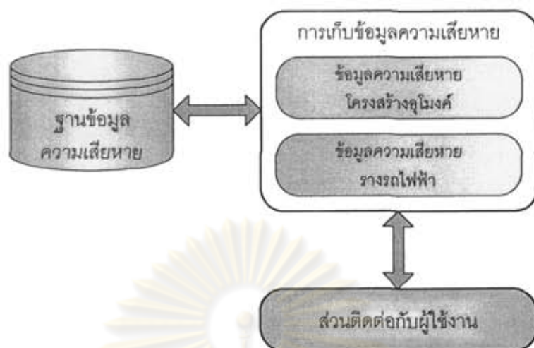
รูปที่ 6.28 โครงสร้างการทำงานของโปรแกรมเก็บข้อมูลสภาพอุโมงค์รถไฟฟ้าใต้ดิน
