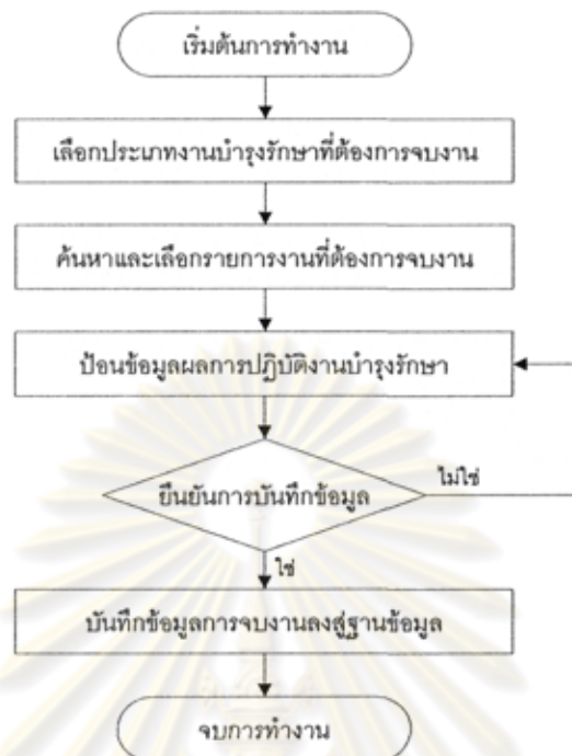
รูปที่ 6.22 การทำงานของมอดูลการจบงาน
