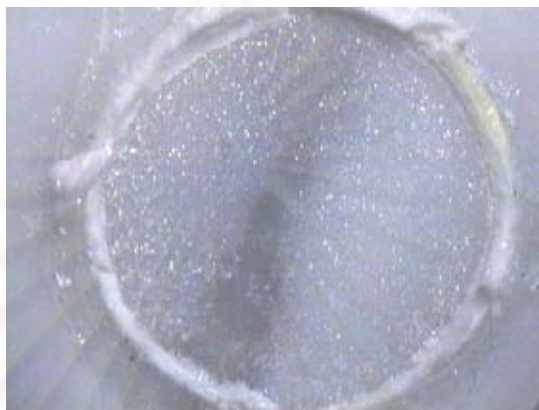
ภาพแสดงชิ้นงานที่เกิดความล้มเหลวของการยึดติดระหว่างผิวเนื้อพ่นกับซีลเลอร์
