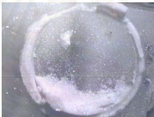
ภาพแสดงชิ้นงานที่เกิดความล้มเหลวของการยึดติดระหว่างผิวเนื้อพ่นกับซีลเลอร์และภายในชั้นซีลเลอร์
