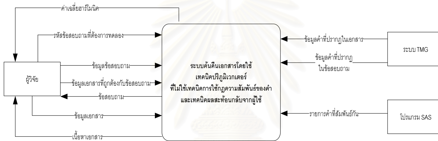
รูปที่ ๓.4 รูปแสดงแผนภาพการไหลของข้อมูลบริบท (Context Diagram) ของการค้นคืนเอกสารที่ใช้เทคนิคปริภูมิเวกเตอร์ร่วมกับเทคนิคการใช้กฎความสัมพันธ์ของคำ
