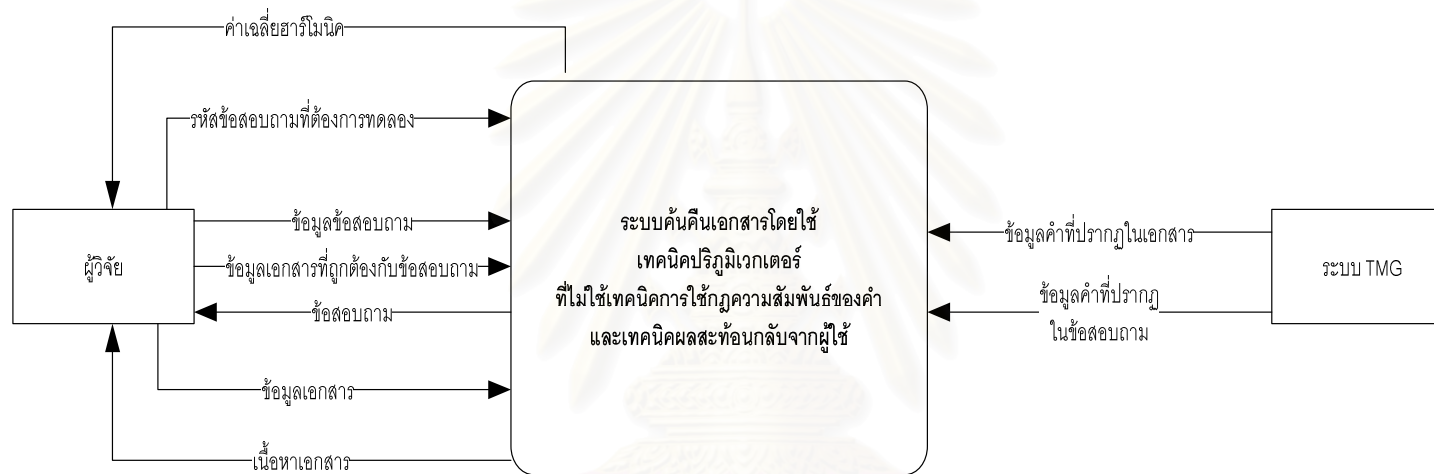
รูปที่ ๒.๒ รูปแสดงแผนภาพการไหลของข้อมูลบริบท (Context Diagram) ของการค้นคืนเอกสารระบบค้นคืนเอกสารที่ใช้เทคนิคปริภูมิเวกเตอร์ที่ไม่ใช้เทคนิคการใช้กฎความสัมพันธ์ของคำร่วมกับเทคนิคผลสะท้อนกลับจากผู้ใช้
