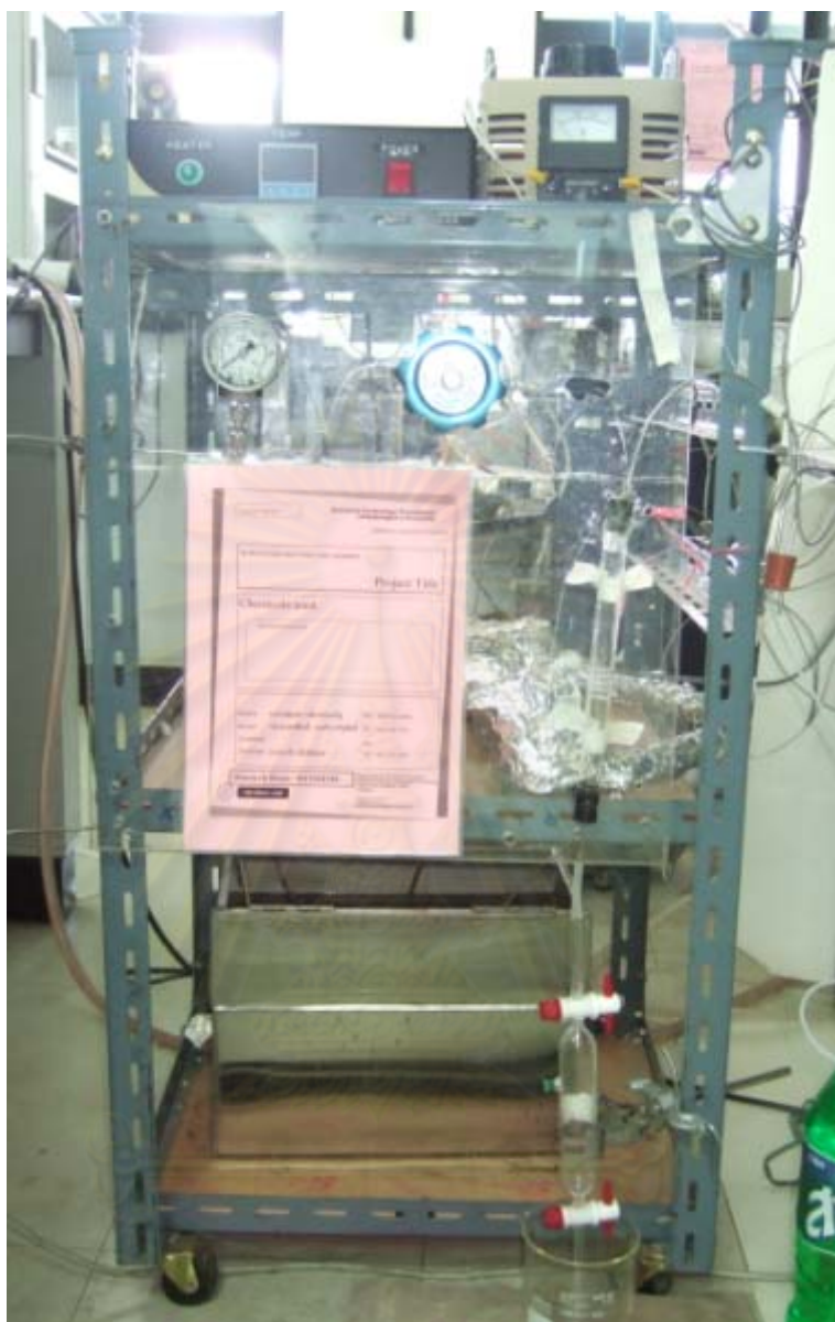
รูปที่ 3.2 เครื่องปฏิกรณ์เชิงเร่งปฏิกิริยาขนาดกะทัดรัดสำหรับปฏิกิริยาออกซิเดชันในน้ำ ภาวะเหนือวิกฤต
