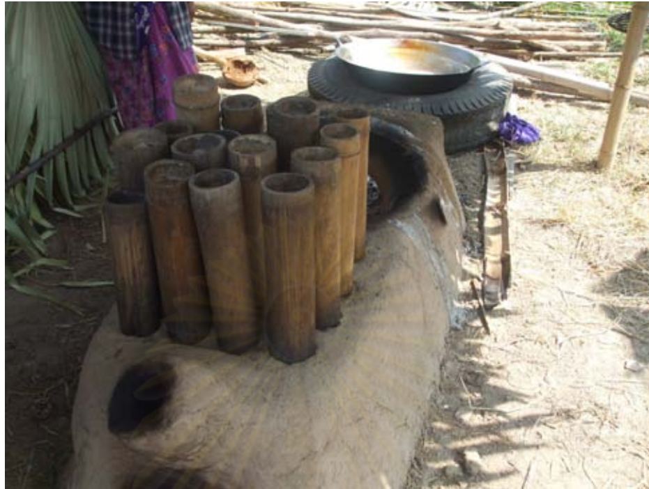
ภาพที่ 42 เต้าเคี้ยวน้ำตาลโตนดแบบเต้าเดียว
