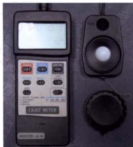
รูปที่9 แสดงเครื่องวัดความส่องสว่างของแสง(Digital Lux Meter) Model LX-70
