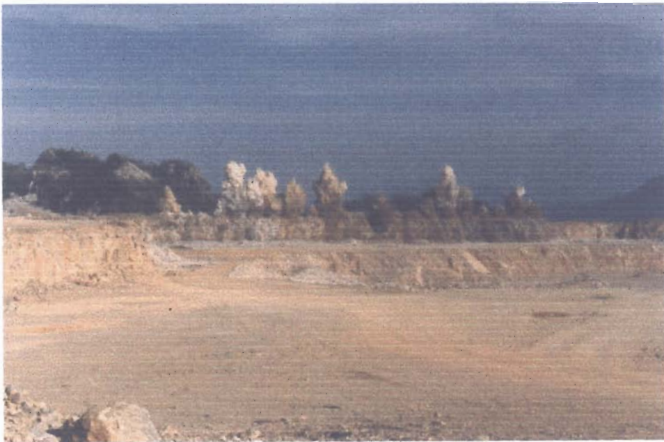
รูปที่ 1.3 ภาพถ่ายการระเบิดเพื่อผลิตหินในอุตสาหกรรมซีเมนต์ สำหรับเหมืองหินขั้นบันไดขนาดใหญ่ ในภาพแสดงผลของการจุดระเบิดโดยใช้แท่งไฟฟ้าถ่วงจังหวะระหว่างแถว ภาพนี้ถ่ายที่เหมืองหินของบริษัทปูนซีเมนต์นครหลวง สระบุรี (21 พ.ย. 2539)
