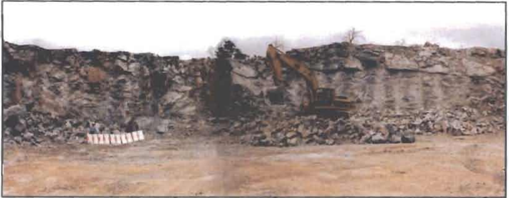
รูปที่ 2.1 เหมืองหินปูนขนาดปานกลาง ผลิตหินย่อยใช้ในงานก่อสร้าง โรงโมหินศิลาสากลพัฒนา อำเภอปากช่อง จังหวัดนครราชสีมา
