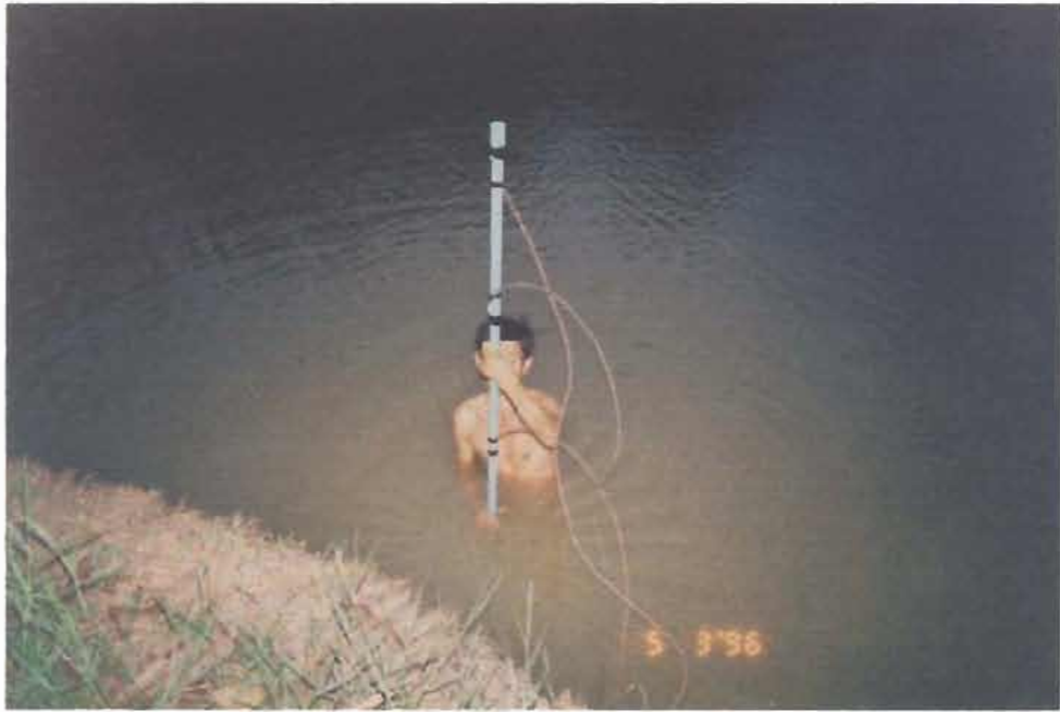
รูปที่ 1-12 แสดงการติดตั้งสาย THERMOCOUPLE ในน้ำ
