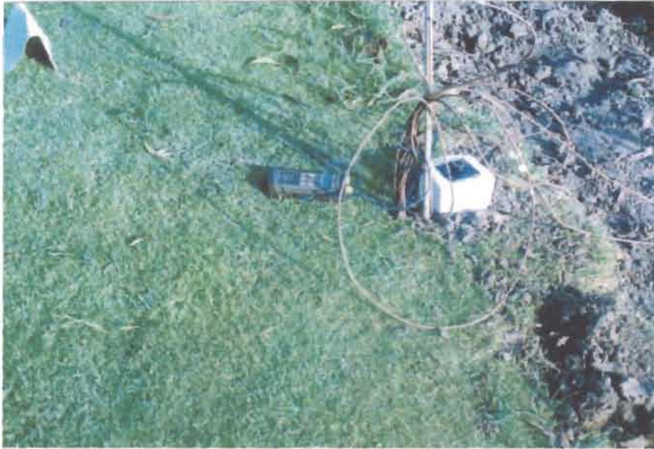
รูปที่ 1-14 แสดงการอ่านอุณหภูมิโดยต่อสายของ SELECTOR SWITCH เข้ากับเครื่องอ่านชนิด MICROPROCESSOR THERMOMETER
