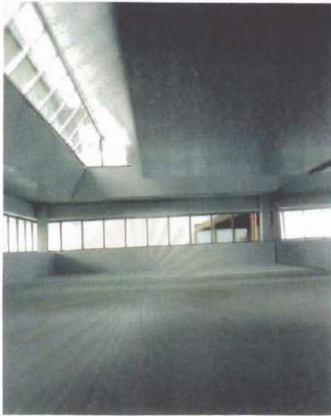
รูปที่ 3-16 แสดงบรรยากาศในหุ้่นจำลองทดสอบแสงธรรมชาติชั้นสำนักงาน
