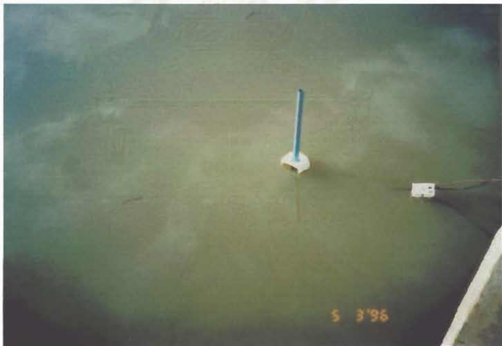
รูปที่ 1-13 แสดงการป้องกันค่า RADIATION โดยติดแผ่นโฟมเหนือปลาย ของสาย THERMOCOUPLE
