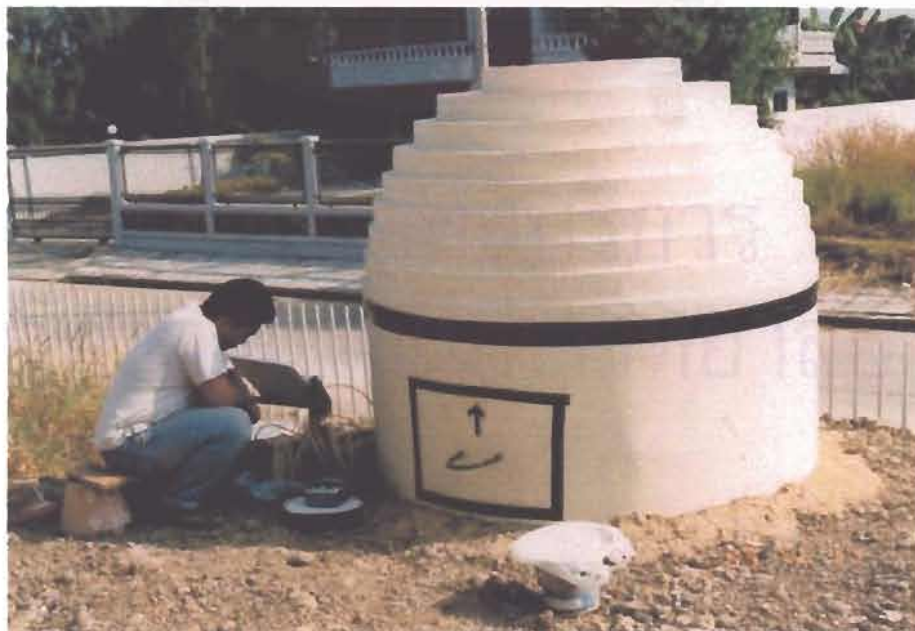
รูปที่ 3-9 แสดงวิธีการวัดค่าการส่องสว่างภายในหุ้่นจำลอง โคม
