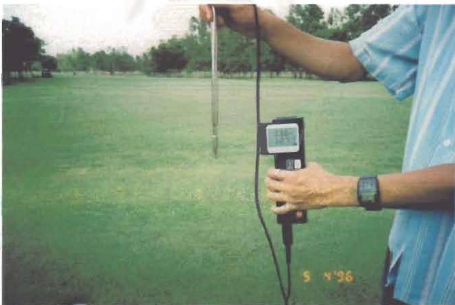
รูปที่ 1-15 แสดงการอ่านค่าความเร็วลมโดยใช้เครื่องมือของ TESTO รุ่น TESTO 491
