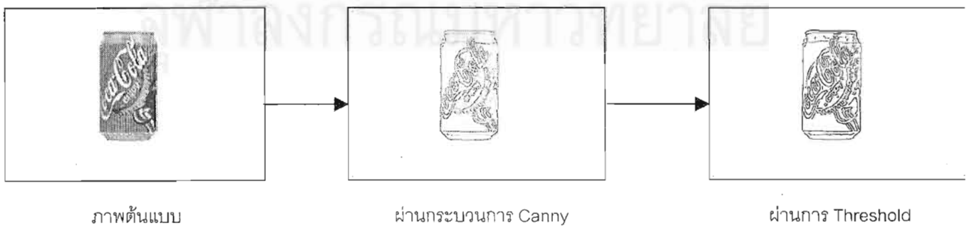
Fig 3.3-14 ภาพแสดงผลลัพธ์ที่ได้จากโปรแกรม CANNY
