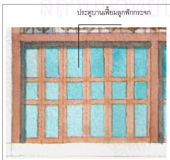
ภาพที่ 158. ประตูบานเพ็ยมลูกฟักกระจก เพื่อให้สามารถมองเห็นภายในอาคารได้ และยังสามารถคงลักษณะของประตูบานเพ็ยมไว้
