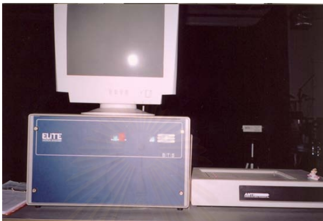
ภาพที่ 3.7 จอ Monitor (ด้านซ้าย) และตัวแปลงและขยายสัญญาณ analog to digital ที่ต่อกับ force plate (ด้านขวา)
