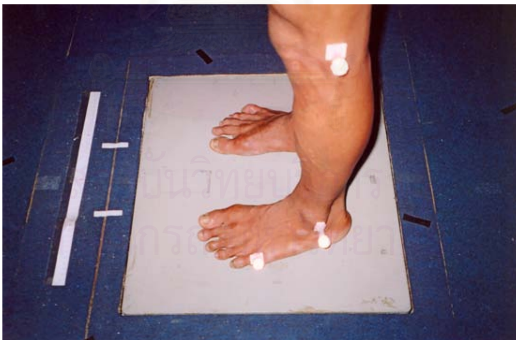
ภาพที่ 3.8 ผู้เข้าร่วมการวิจัยขณะยืนทดสอบบน force plate ในภาพแสดงถึง marker ที่ตำแหน่ง knee joint ankle joint และ head of 5 th metatarsal
