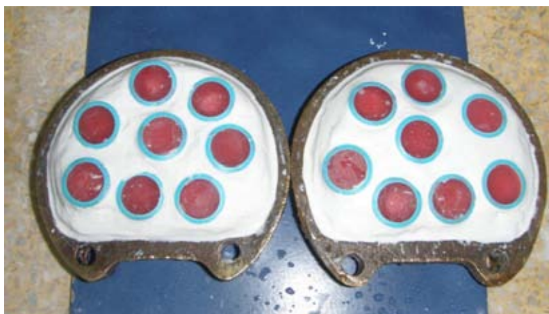
ภาพที่ 4 ท่อน้ำพีวีซีที่มีซี่ฝั้ง มาลงในแบบภาชนะหล่อทองเหลือง (Hanau flask)
