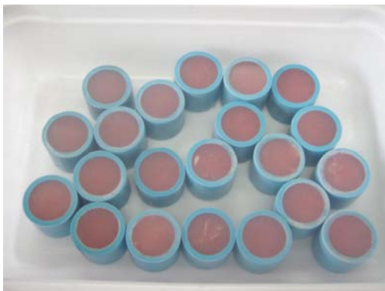
ภาพที่ 7 ชิ้นงานท่อน้ำพีวีซีที่มีอะคริลิกบรรจุอยู่ตรงกลาง
