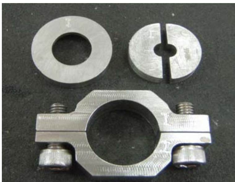
ภาพที่ 10. แสดงแม่แบบโลหะเหล็กกล้าไร้สนิมที่สามารถแยกชิ้นส่วนได้
