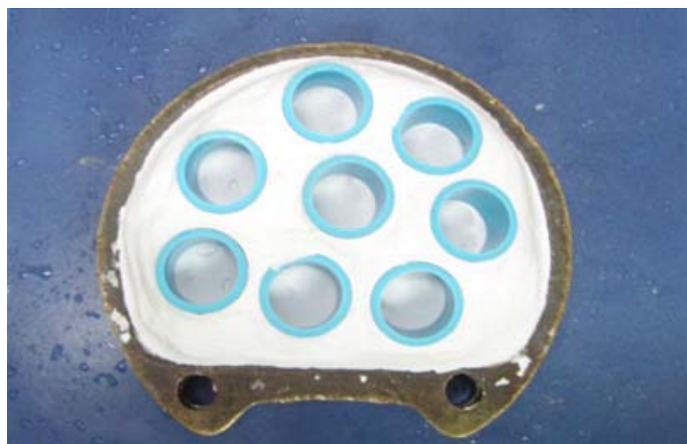
ภาพที่ 4 ท่อน้ำพีวีซีที่มีซี่ฝั้ง มาลงในแบบภาชนะหล่อทองเหลือง (Hanau flask)
