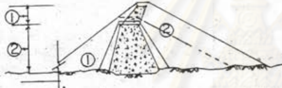
(จ) การเสริมสันเขื่อน แบบ Trickcore-Rockfill Dam.
