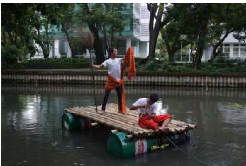
ภาพที่ 8 แสดงการออกแบบอุปกรณ์การแสดงโดยใช้ถังน้ำมันและไม้ไผ่มาต่อทำเป็นแพ ที่มา: ผู้วิจัย
