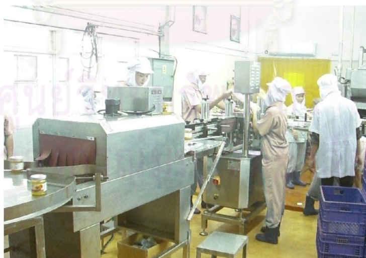
รูปที่ 4.26 การเชื่อมสายพานเข้ากับเครื่องบรรจุปิดปากฝา
