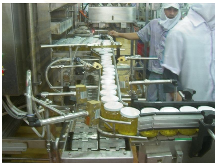
รูปที่ 4.24 การติดตั้งเครื่องเป่าแห้ง
