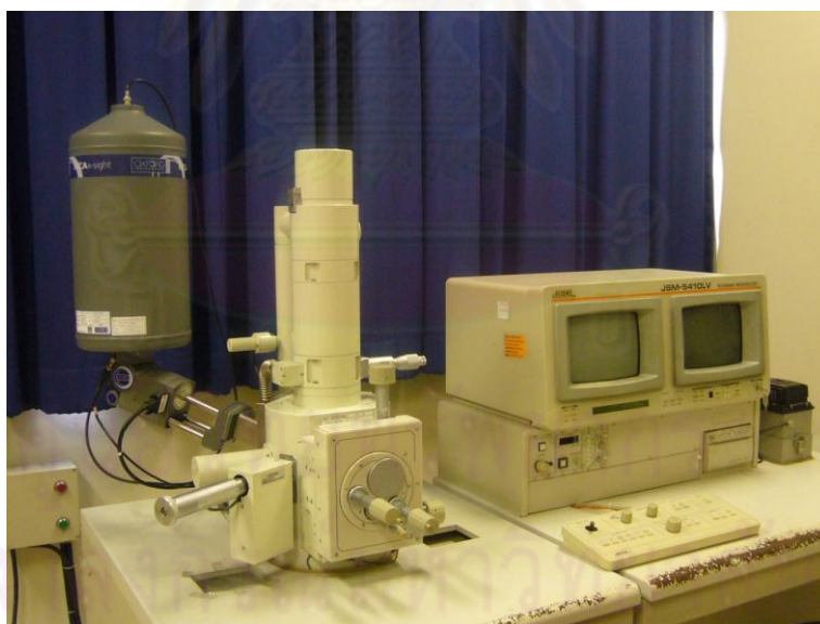
ภาพแสดง กล้องจุลทรรศน์อิเล็กตรอนแบบส่องกราด (JSM 5410LV, JEOL, Tokyo, Japan)
