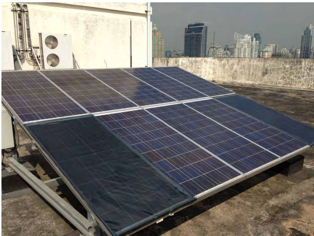
รูปที่ 11.28 การทดลองผลกระทบของการบังแสงแดดต่อเซลล์แสงอาทิตย์
