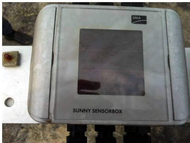
รูปที่ 9.4 อุปกรณ์ส่วนตรวจวัดความเข้มแสงจากบริษัท SMA Solar จำกัด (มหาชน) รุ่น Sunny
