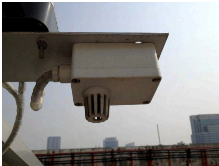
รูปที่ 9.5 อุปกรณ์สำรวจวัดอุณหภูมิจากบริษัท SMA Solar จำกัด (มหาชน) รุ่น Sunny
