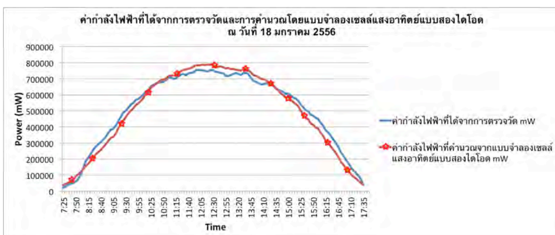
รูปที่ 11.34 การเปรียบเทียบค่าของกำลังไฟฟ้าที่ได้จากการตรวจวัดจริงกับการคำนวณจากแบบจำลองเซลล์แสงอาทิตย์แบบสองไดโอด ณ วันที่ 18 มกราคม 2556
