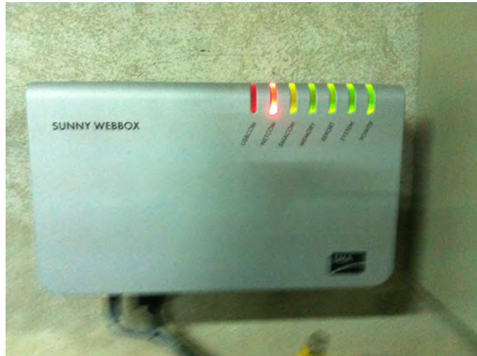
รูปที่ 9.6 ตัวเก็บข้อมูลจากบริษัท SMA Solar จำกัด (มหาชน) รุ่น Sunny webbox
