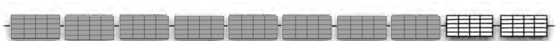
รูปที่ 10.21 ลักษณะของสตริงเมื่อเกิดการบังแสงแดดบนเซลล์แสงอาทิตย์จำนวน 8 โมดูล
