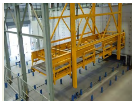
ภาพที่ 3.20 โต๊ะหล่อขณะเข้าตู้อบตู้อบ
