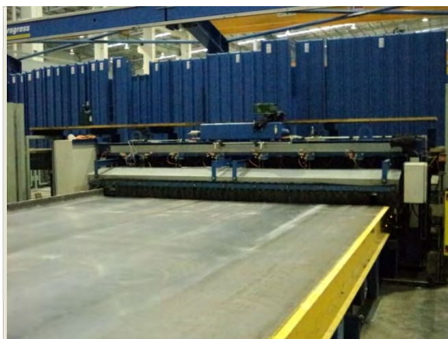
ภาพที่ 3.7 เครื่องพ่นน้ำมัน ที่มา: ฝ่ายการผลิต บริษัท พฤษภา ฯ
