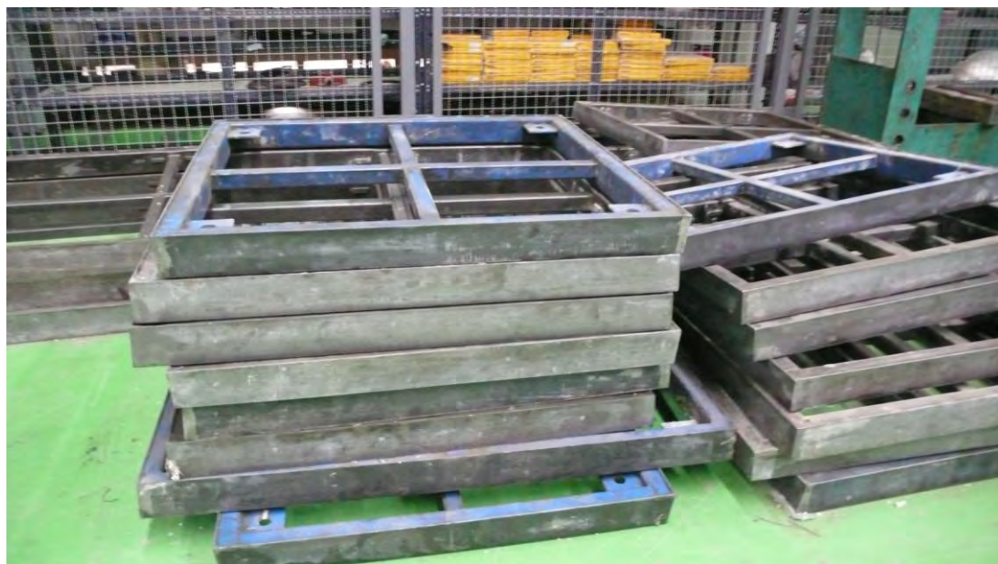
ภาพที่ 5.1 ระยะของแบบหล่อที่มีขนาดใกล้เคียงกัน ส่งผลให้เกิดความสับสนในการทำงาน
