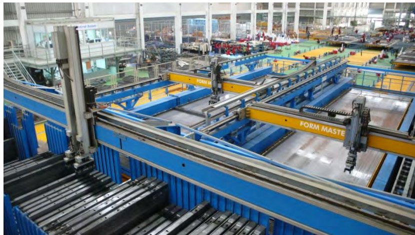
ภาพที่ 3.10 หุ่นยนต์อัตโนมัตินำเหล็กกันแบบข้างไปติดตั้งบนโต๊ะหล่อ ที่มา: จากการสำรวจ
