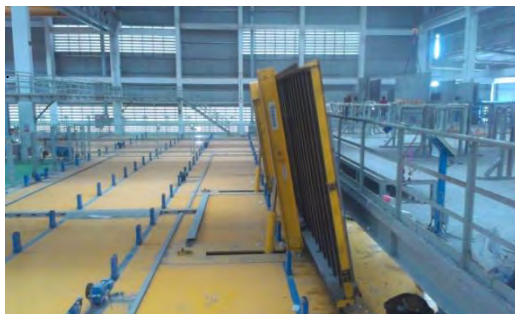
ภาพที่ 3.22 โต๊ะหล่อถูกยกเอียงประมาณ 85 องศา
