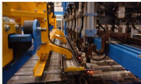
ภาพที่ 3.13 เครื่องผลิตตะแกรงเหล็กขณะกำลังผลิต ที่มา: ฝ่ายการผลิต บริษัท พฤษา ฯ
