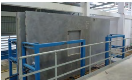
ภาพที่ 3.24 ชิ้นงานจะถูกยกเก็บใส่ตะกร้าเหล็ก
