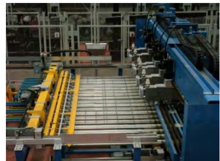
ภาพที่ 3.14 เครื่องผลิตตะแกรงเหล็ก ที่มา: ฝ่ายการผลิต บริษัท พฤษา ฯ
