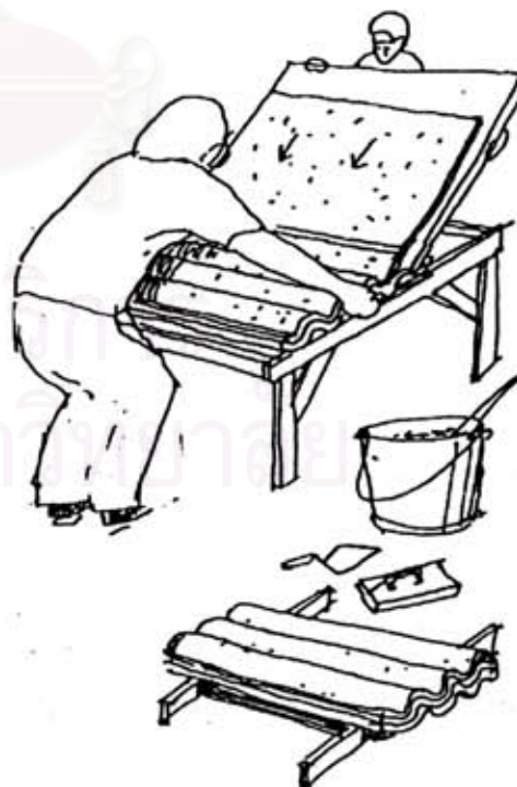
รูปภาพที่ 6.13 กระเบื้องผสมใยเปลือกมะพร้าว
