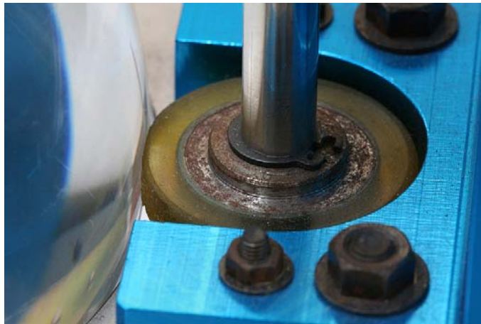
รูปที่ 5.2 ล้อยูรีเทนที่มีความแข็งน้อยเกินไป เมื่อประกอบกับชุด Double CVT
