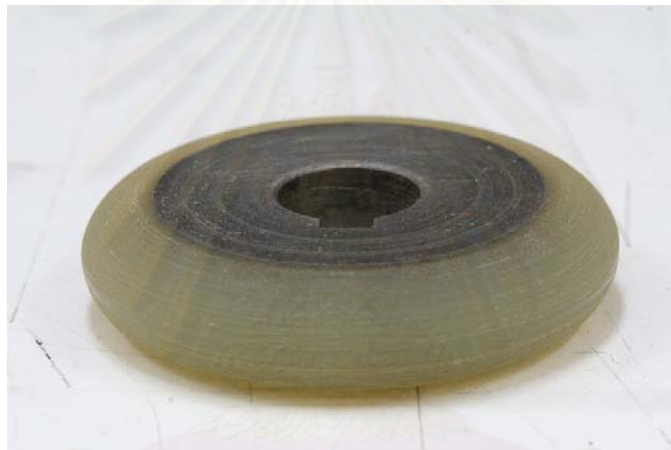
รูปที่ 5.3 ล้อยูรีเทนที่มีความแข็ง 95 Shore A
