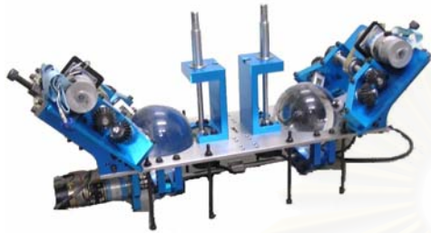
รูปที่ 4 รูปต้นแบบจริงของอุปกรณ์ส่งถ่ายความเร็วแบบปรับอัตราทดได้ต่อเนื่อง Double CVT
