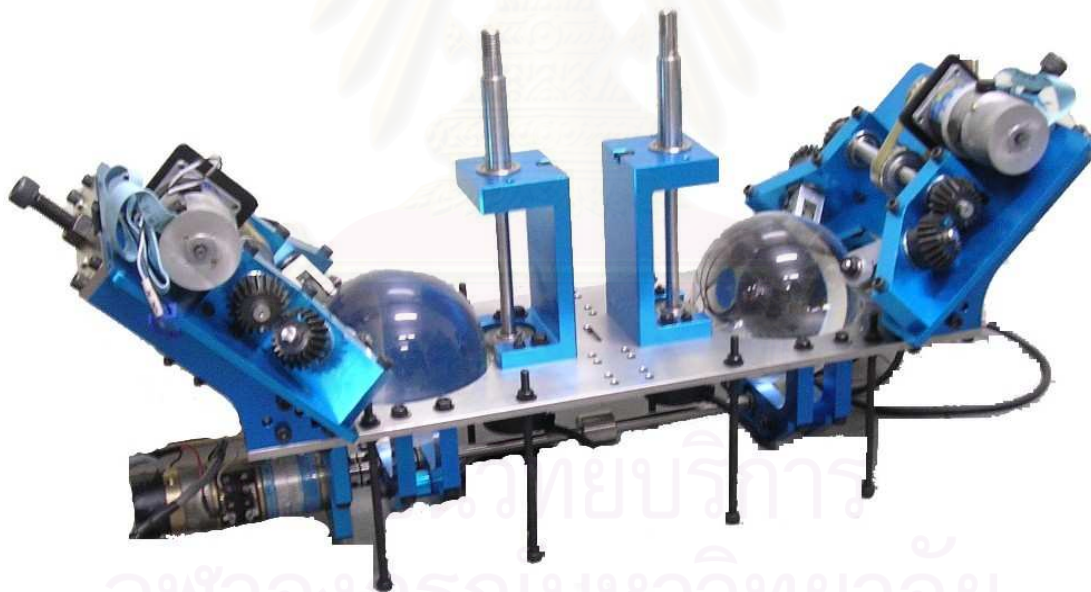
รูปที่ 2.11 ต้นแบบจริงของอุปกรณ์ส่งถ่ายความเร็ว แบบปรับอัตราทดได้ต่อเนื่อง Double CVT
