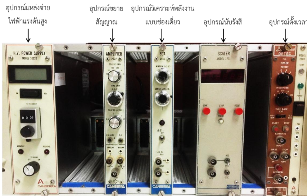
รูปที่ 3.4 อุปกรณ์แหล่งจ่ายไฟฟ้าแรงดันสูง อุปกรณ์ขยายสัญญาณ อุปกรณ์วิเคราะห์พลังงานแบบช่องเดียว และอุปกรณ์นับรังสีและตั้งเวลา
