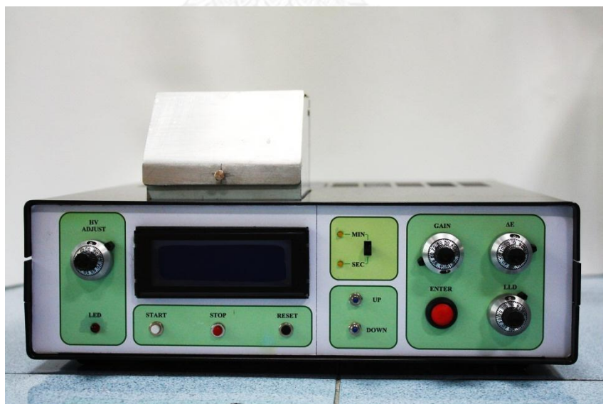
รูปที่ 3.11 ด้านหน้าของอุปกรณ์จำแนกประเภทของเหลวแบบพกพา
