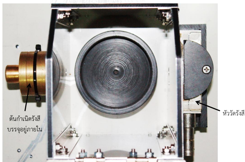
รูปที่ 3.10 ด้านบนของอุปกรณ์วางต้นกำเนิดรังสี ขวดบรรจุของเหลว และหัววัดรังสี
