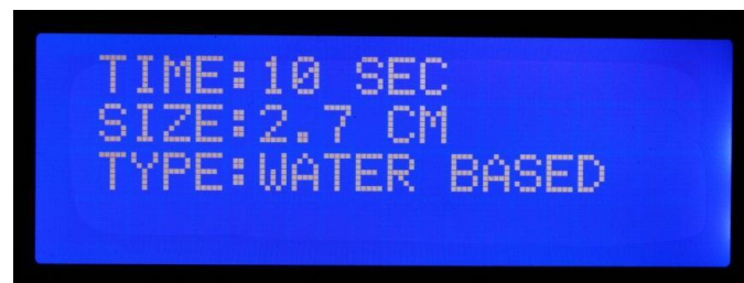
รูปที่ 3.15 หน้าจอแอลซีดีแสดงผลขั้นตอนการจำแนกประเภทของเหลว
