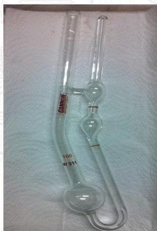
ภาพที่ 3 - 6 เครื่องมือวัดความหนืด (Viscometer)
