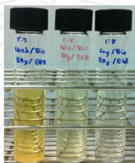
ภาพที่ ค - 13 จุดศูนย์กลางของเชื้อเพลิงชีวภาพไมโครอิมัลชัน โดยใช้สารลดแรงตึงผิวดีไฮดอลเอทิลีน ออกไซด์5 สารลดแรงตึงผิวร่วมเอทิลีนไกลคอลบิวทิลอีเทอร์ อุณหภูมิ 6 องศาเซลเซียส ที่เวลา 1 วัน
