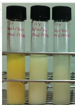
ภาพที่ ค - 27 จุดไหลเทของเชื้อเพลิงชีวภาพไมโครอิมัลชัน โดยใช้สารลดแรงตึงผิวโอเลอิล แอลกอฮอล์ สารลดแรงตึงผิวร่วมเอทิลีนไกลคอลบิวทิลอีเทอร์ ที่อุณหภูมิ -6 องศาเซลเซียส
