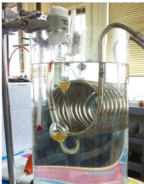
ภาพที่ ก - 1 การติดตั้งอุปกรณ์การวัดความหนืด ที่อุณหภูมิ 15 และ 25 องศาเซลเซียส
