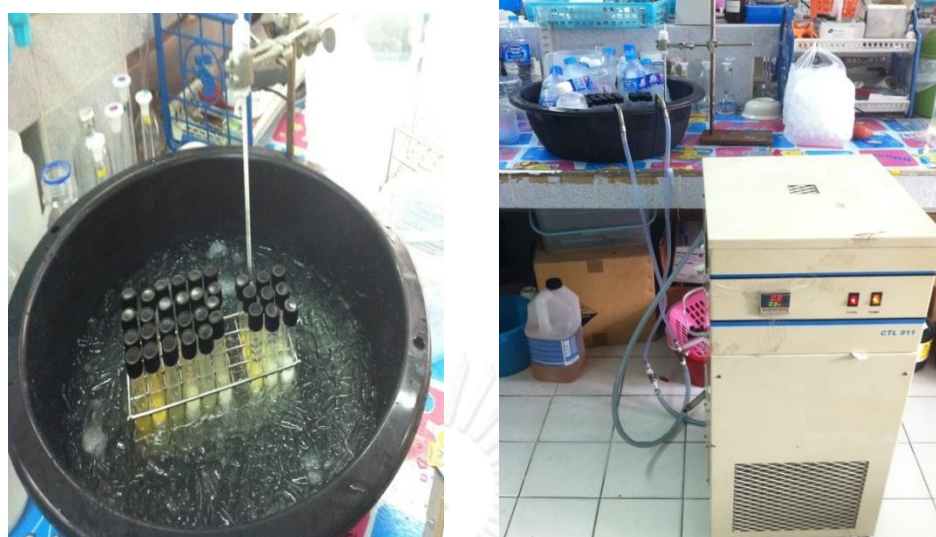
ภาพที่ ก - 3 การติดตั้งอุปกรณ์การวัดจุดไหลเทของเชื้อเพลิงชีวภาพไมโครอิมัลชัน
