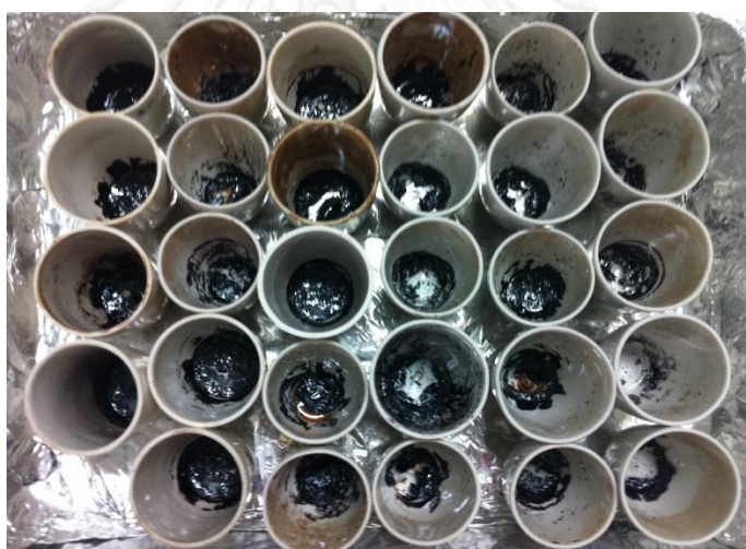
ภาพที่ ค - 30 ปริมาณเก่าของเชื้อเพลิงชีวภาพไมโครอิมัลชันหลังเข้าเตาเผา ที่อุณหภูมิ 550 องศาเซลเซียส เวลา 1 ชั่วโมง
