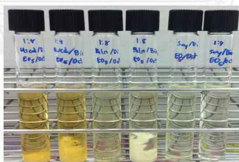
ภาพที่ ค - 17 จุดขุ่นของเชื้อเพลิงชีวภาพไมโครอิมัลชัน โดยใช้สารลดแรงตึงผิวดีไฮดอลเอทิลีน ออกไซด์5 สารลดแรงตึงผิวร่วมออกทานอล อุณหภูมิ 6 องศาเซลเซียส ที่เวลา 30 วัน
