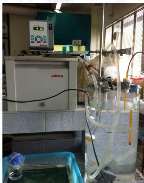
ภาพที่ ก - 2 การติดตั้งอุปกรณ์การวัดความหนืด ที่อุณหภูมิ 30 และ 40 องศาเซลเซียส
