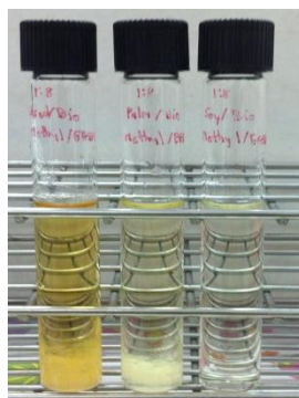
ภาพที่ ค - 21 จุดขุ่นของเชื้อเพลิงชีวภาพไมโครอิมัลชัน โดยใช้สารลดแรงตึงผิวเมทิลโอลิเอต สารลดแรงตึงผิวร่วมเอทิลีนไกลคอลบิวทิลอีเทอร์ อุณหภูมิ 6 องศาเซลเซียส ที่เวลา 30 วัน
