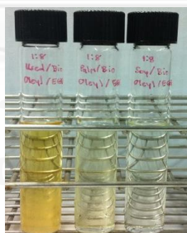
ภาพที่ ค - 14 จุดศูนย์กลางของเชื้อเพลิงชีวภาพไมโครอิมัลชัน โดยใช้สารลดแรงตึงผิวโอเลิลแอลกอฮอล์ สารลดแรงตึงผิวร่วมเอทิลีนไกลคอลบิวทิลอีเทอร์ อุณหภูมิ 6 องศาเซลเซียส ที่เวลา 1 วัน
