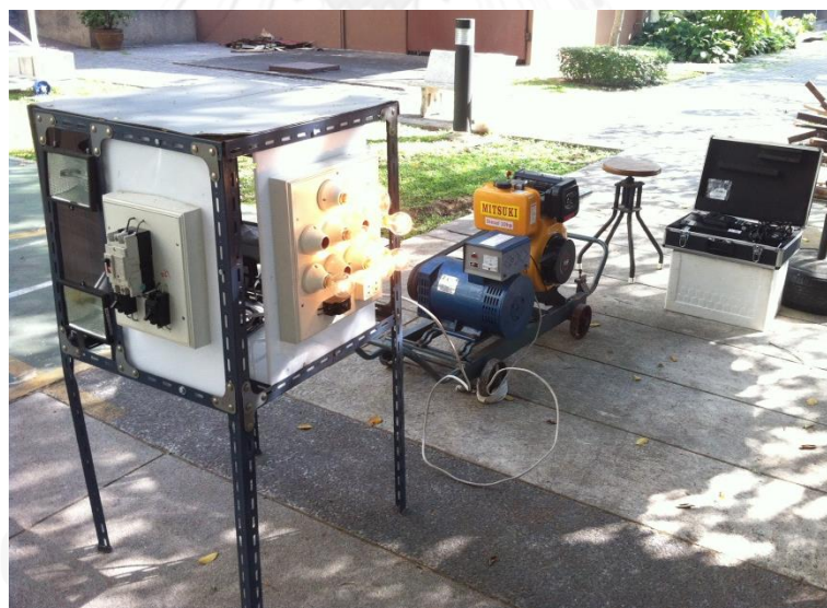
ภาพที่ ก - 4 การติดตั้งอุปกรณ์การวัดประสิทธิภาพและการปล่อยก๊าซไอเสียของเชื้อเพลิงชีวภาพไมโครอิมัลชัน
