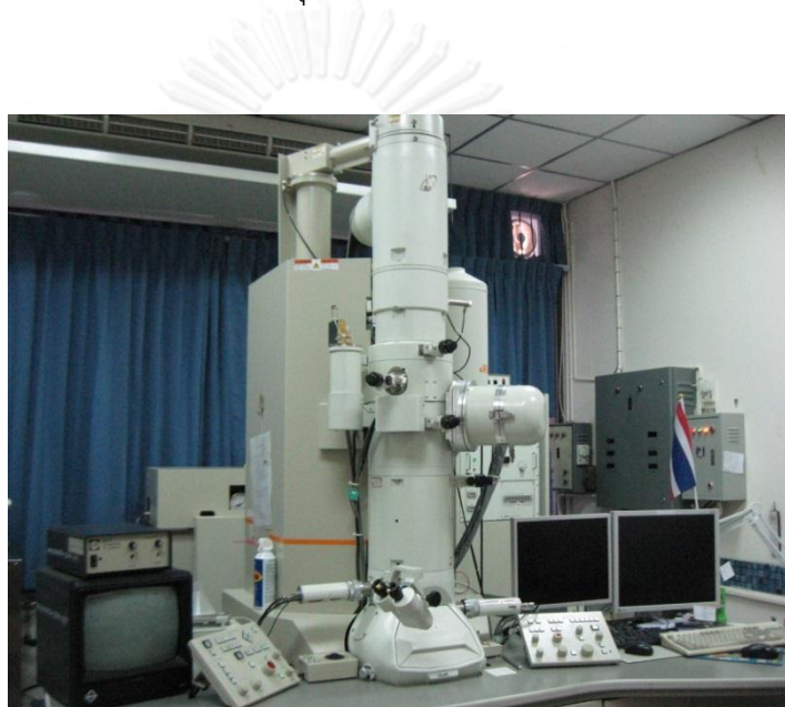
รูปที่ 3. 6 แสดงกล้องจุลทรรศน์อิเล็กตรอนชนิดส่องผ่าน (TEM) ของบริษัท JEOL รุ่น JEM-2100 ที่ใช้ในงานวิจัย
