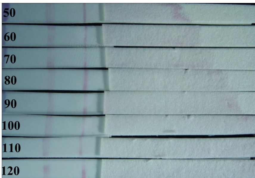
รูปที่ 4. 12 ผลของปริมาณสิ่งส่งตรวจที่ใช้หยดลงบน sample pad ต่อความเข้มของเส้นทดสอบและเส้นควบคุม
