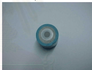
รูปที่ 8 แสดง ก. เทปกาวด้านเดียวเส้นผ่าศูนย์กลาง 5.5 มิลลิเมตร ข. การติดเทปกาวลงบนกึ่งกลางชั้นโลหะขนาดเส้นผ่าศูนย์กลาง 9 มิลลิเมตร
