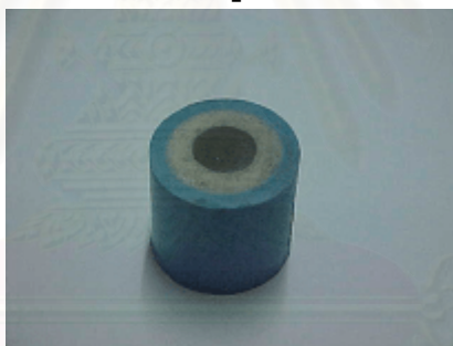
รูปที่ 6 แสดงชิ้นโลหะขนาดเส้นผ่าศูนย์กลาง 9 มิลลิเมตรที่ยึดติดกับท่อพีวีซีด้วย อะคริลิกชนิดเกิดปฏิกิริยาแข็งตัวทางเคมี
