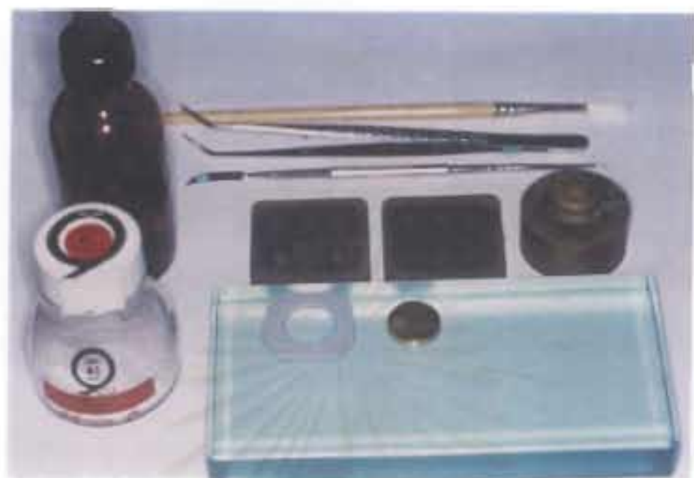
รูปที่ 3-1 แสดงวัสดุอุปกรณ์ในการเตรียมชิ้นงานไดแทค ผงพอร์ซเลนวิต้า โธเมก้า 900, น้ำกลั่น, แอมโมเนียมซีลีโคน, ฝุ่นน้ำหนักขนาด 200 กริม, และครรณ คาร์เวอร์
