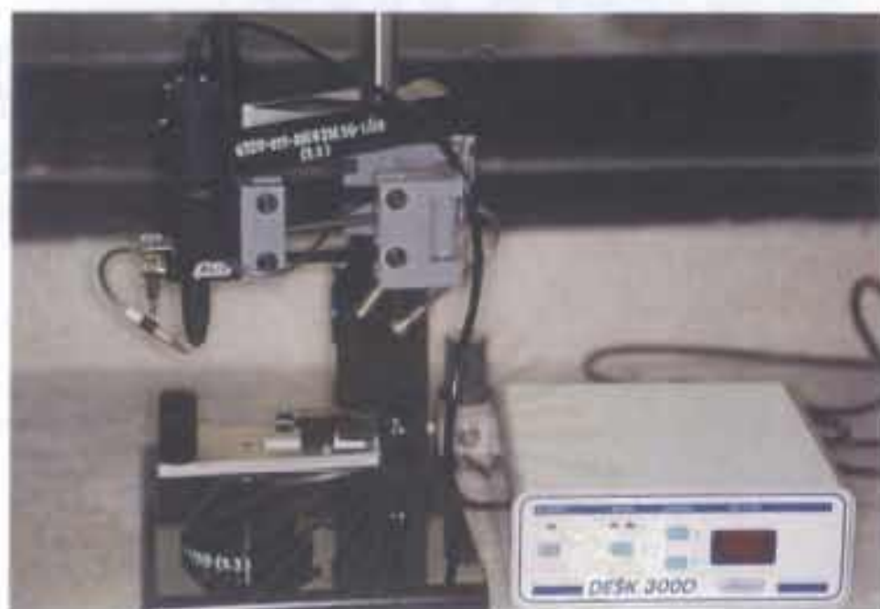
รูปที่ 3-5 แสดงเครื่องกรรขี้นงาน ซึ่งมีด้ามจับหัวกรรขี้นติดกับแกนแนวตั้ง และฐานยึดเป็นจับขี้นงาน
