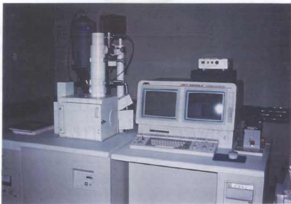
รูปที่ 3-12 แสดงกล้องจุลทรรศน์อิเล็กตรอนชนิดส่องกราด (JEOL รุ่น JSM-5800 LV)
