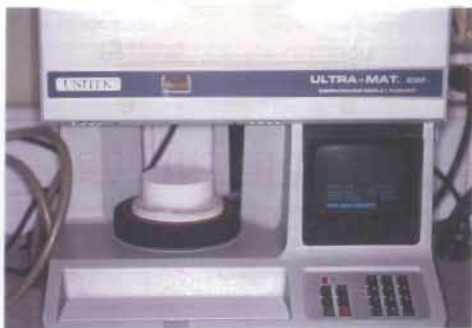
รูปที่ 3-2 แสดงเตาเผาพอร์ซเลนยูนิเทค (Unitek รุ่น Ultra-mat CDF)
