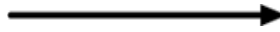
รูปที่ 2.28 สัญลักษณ์แทนเส้นเชื่อมอาร์ซีเอฟจี
