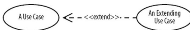
รูปที่ 2.8 สัญลักษณ์แทนความสัมพันธ์แบบเอ็กซ์เทน
