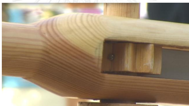
ภาพที่ 4.25 ข้อต่อระหว่างเสากับก้านของกระเตงเวียนเมื่อหมุนจะทำให้เกิดเสียง
