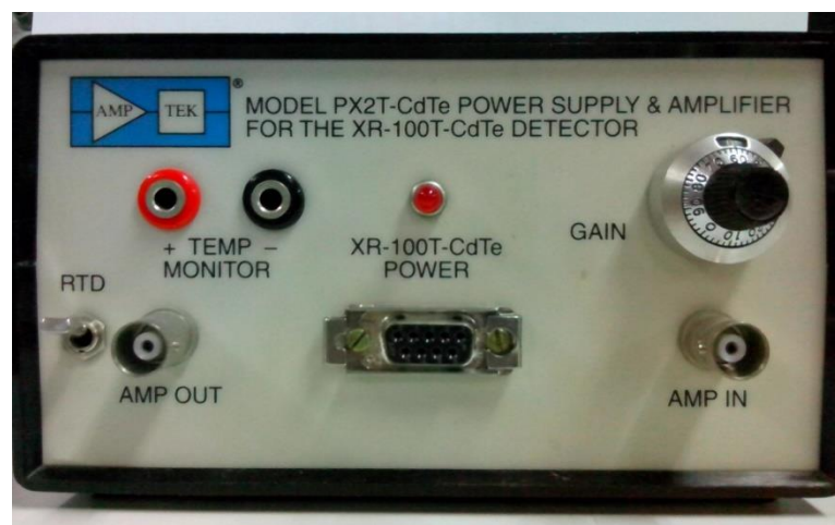
รูปที่ 3.4 อุปกรณ์จ่ายไฟฟ้าศักดาสูงและภาคขยายสัญญาณ รุ่น PX2T-CdTe
