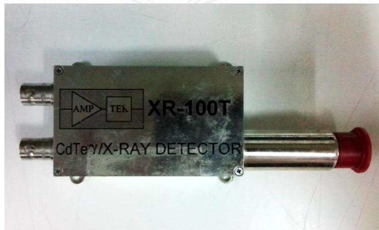
รูปที่ 3.3 หัววัดรังสีเอกซ์ ชนิดแคดเมียมเทลลูไรด์ ขนาด 5 มิลลิเมตร x 5 มิลลิเมตร
