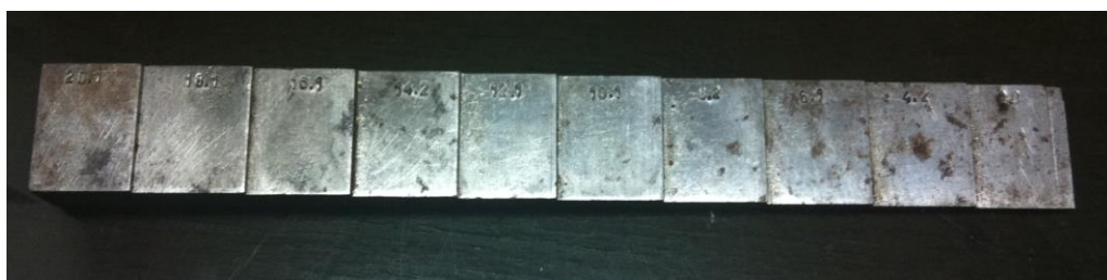
รูปที่ 3.5 เหล็กชั้นบันได ขนาด 1.5 นิ้ว × 12 นิ้ว
