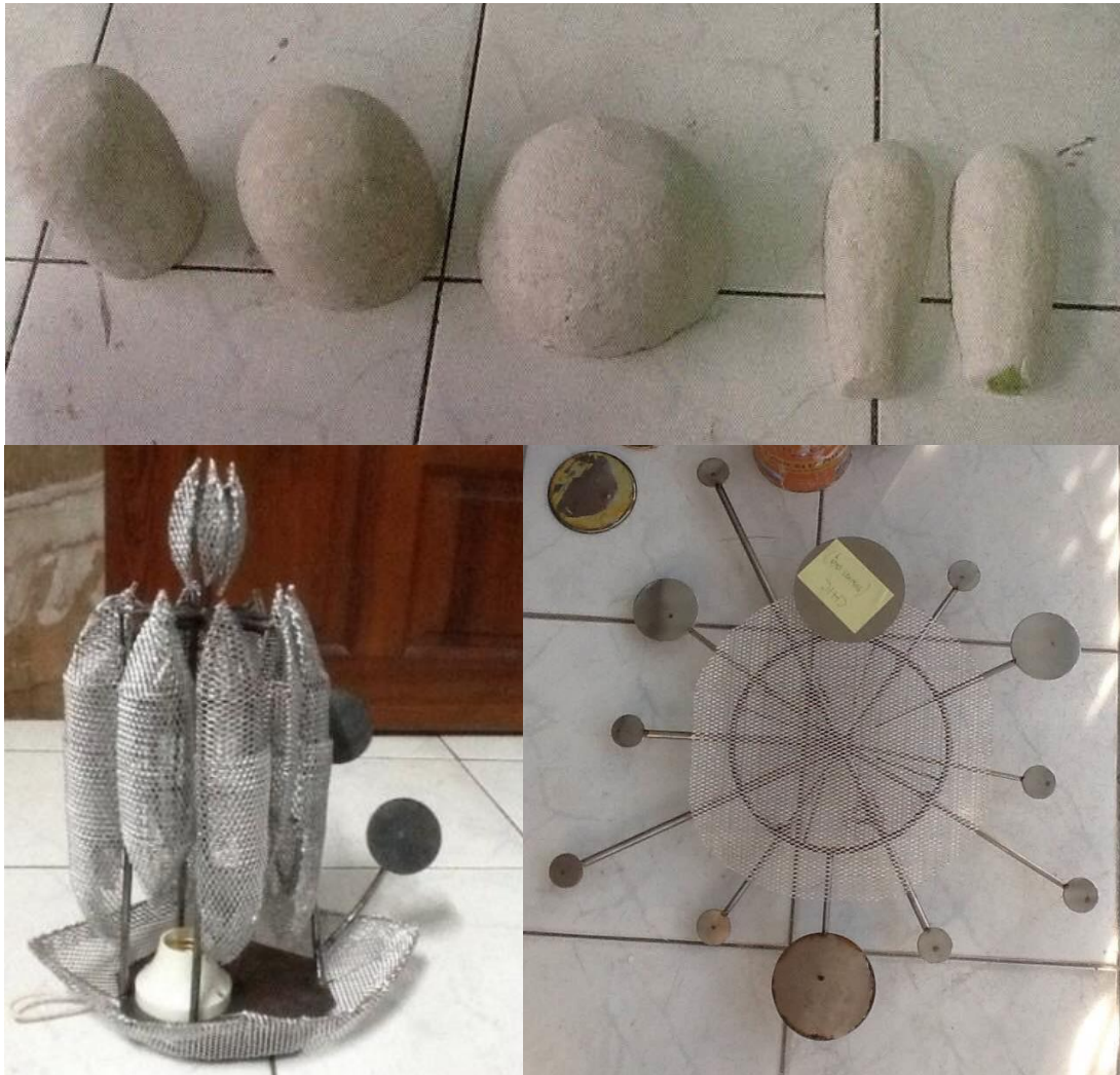
ภาพที่ 116 การขึ้นรูปผลิตภัณฑ์ด้วยการขึ้นโครงสร้างจากแม่พิมพ์ปูนซีเมนต์และตะแกรงลวด ที่มาของภาพ : ผู้วิจัย
